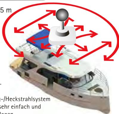
Mit Hilfe der Joystick-technologie und dem integrierten 360° Bug-/Heckstrahlssystem lässt sich die Aquino sehr einfach und sicher steuern und anlegen. Die Aquino hat einen Joystick mit dieser Funktion am Außenfahrstand.
